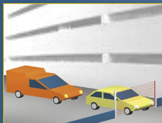
Rilevamento limiti di ingombro di autoveicoli per la movimentazione in parcheggi automatici
